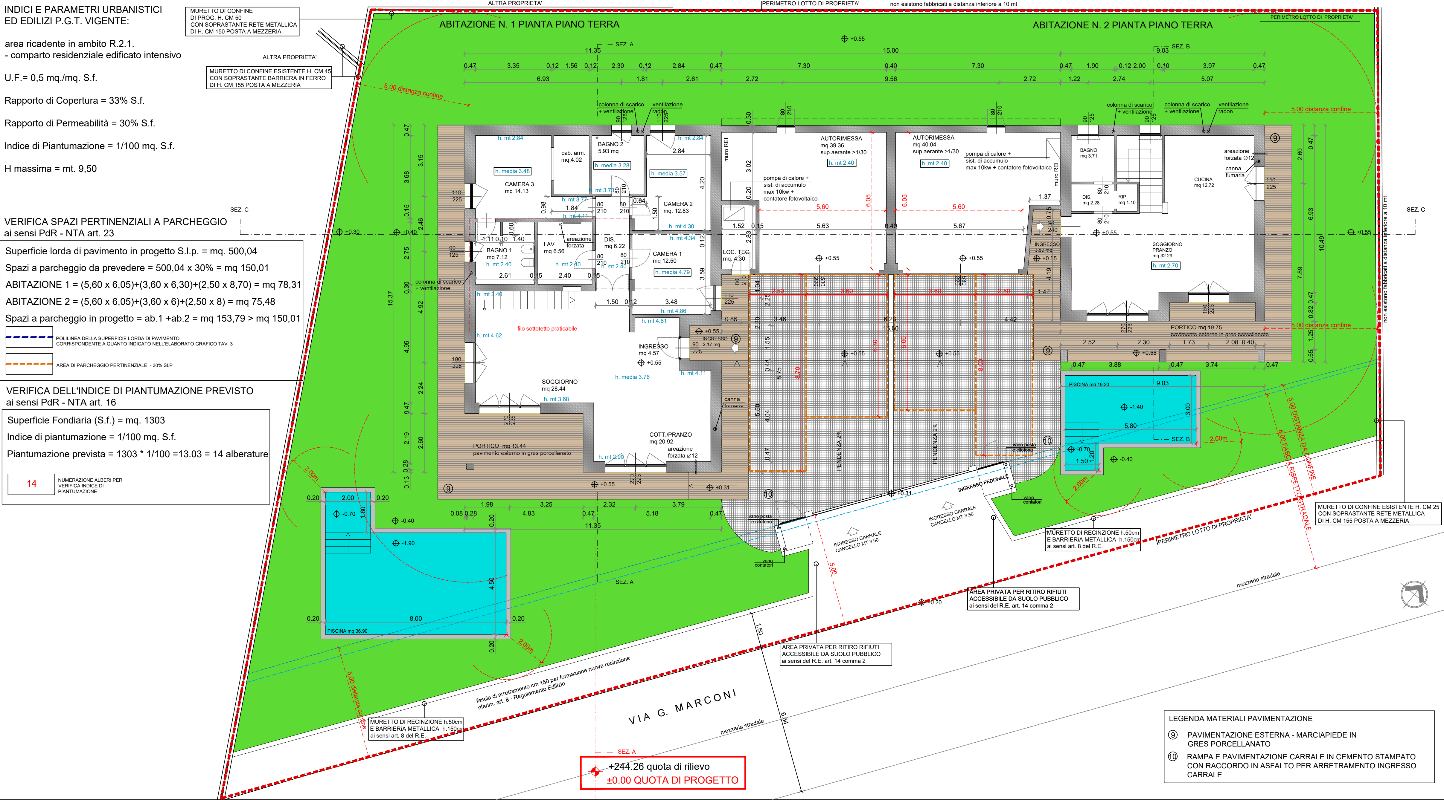
PIANTA PIANO SOTTOTETTO ABITAZIONE N. 1 E PIANTE PIANO PRIMO ABITAZIONE N. 2 STATO IN VARIANTE Scala 1:100
